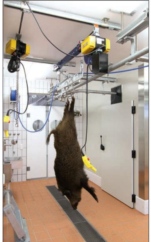
▲ Festeinbau mit Rohrbahnsystem, Waage, Kühlkammer
